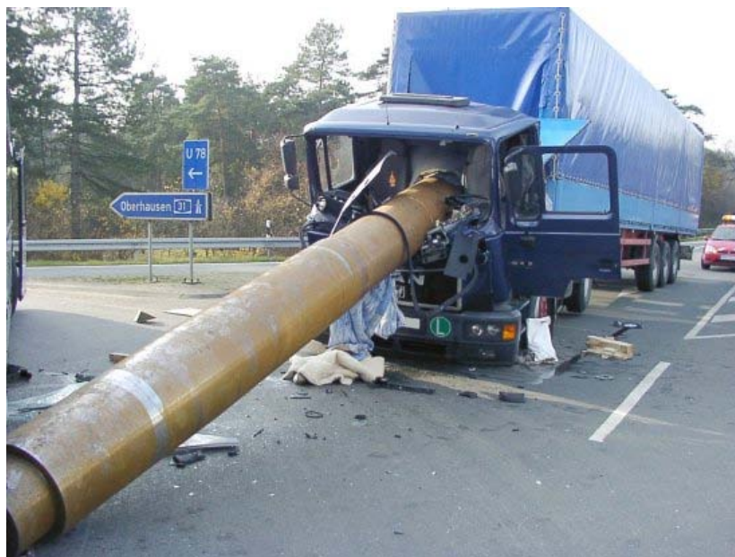
1. ábra: Erős fékezéskor az elégtelenül rögzített acélcsövek áthatoltak a homlokfalon és a vezetőfülkén.
