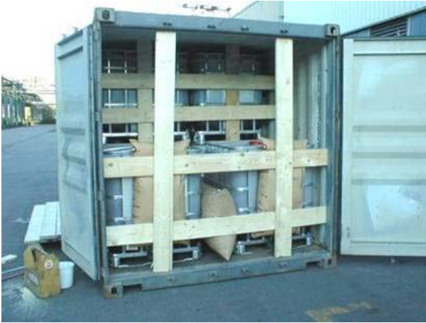
90. ábra: Úgynevezett nagyméretű csomagolóeszközök (IBC-konténerek) két rétegben elhelyezve konténerben
