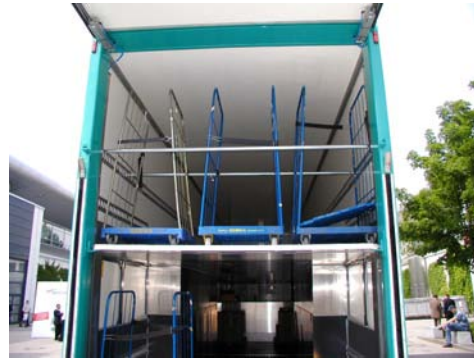
64. ábra: Görgős rakodólap oldaltartókkal és szorítórudakkal
